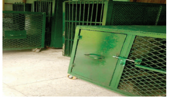
वन्यजन्तु पक्राउको लागि होलिडङ्ग केजको निर्माणः
